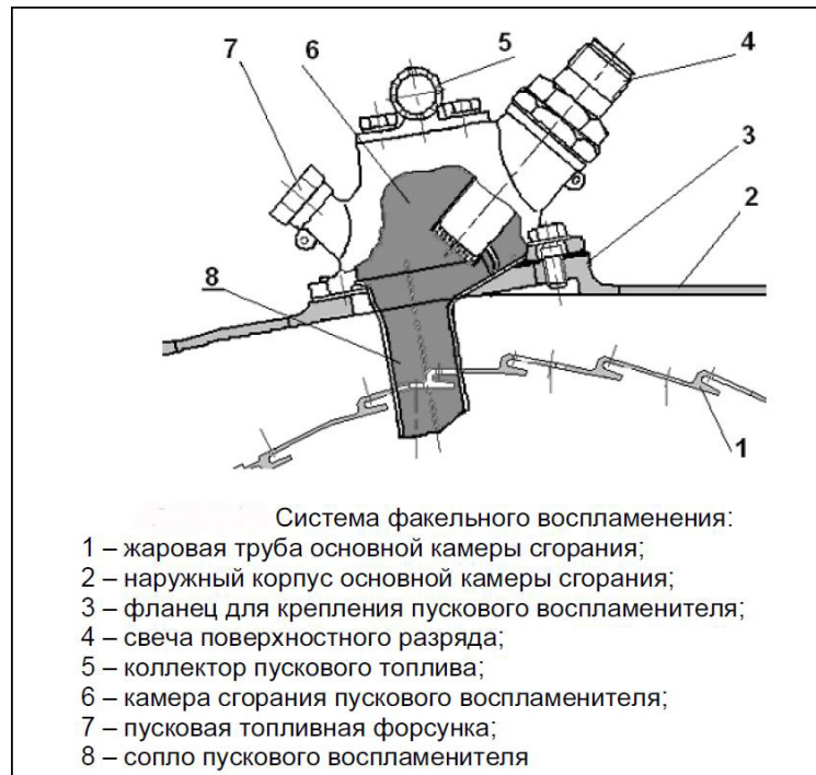
Рисунок 1.4 – Установка воспламенителя на камеру сгорания
