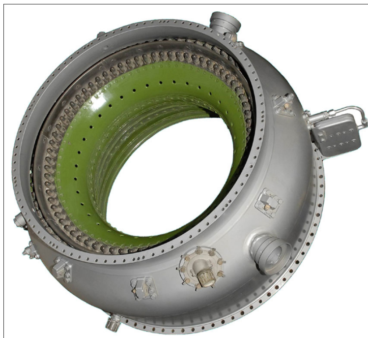
Рисунок 1.2 – Кольцевая камера сгорания двигателя НК-32
